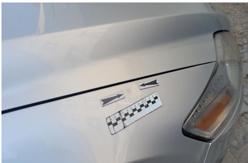
Fot. 26. Błotnik metal PP - deformacja 1
